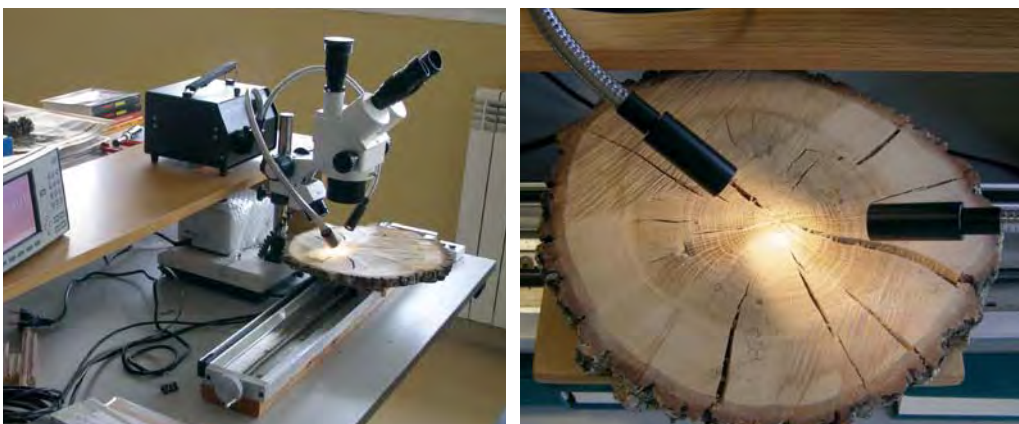
Figura 1.8. Sistema de análisis dendrocronológico (izqda.) y rodaja de rebollo ( Quercus pyrenaica Willd ) lista para su análisis (dcha.)
