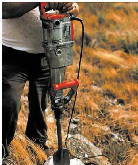
Ahoyadora mecánica. La pala final funciona como un martillo neumático que remueve el suelo. Accionada por batería alimentada por un tractor
