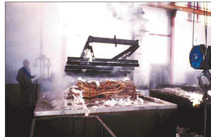
El corcho que llega a fábrica es cocido en depósitos de agua a 100-105 °C durante poco más de una hora. Esta operación ayuda a eliminar los taninos e impurezas y da al corcho unas condiciones de humedad para facilitar el enderezamiento de las panas y facilita la siguiente fase de manipulación del corcho. En la foto sacando el corcho del depósito después de cocido
