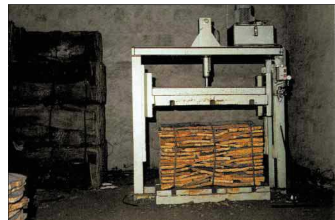
El corcho de calidad suficiente para hacer tapones una vez cocido, clasificado y recortado, es prensado y enfardado en paquetes para su transporte a la fábrica taponera
