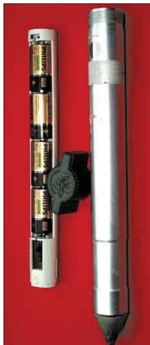
EL "Molechaser" consiste en un tubo hueco dentro del cual se coloca un eje provisto de 4 pilas de 1,5 v y se tapa por la parte superior. El mecanismo produce un ruido de sirena de baja intensidad que en principio ayuda a ahuyentar los topes. Los resultados que nosotros hemos obtenido con su aplicación han sido mediocres
