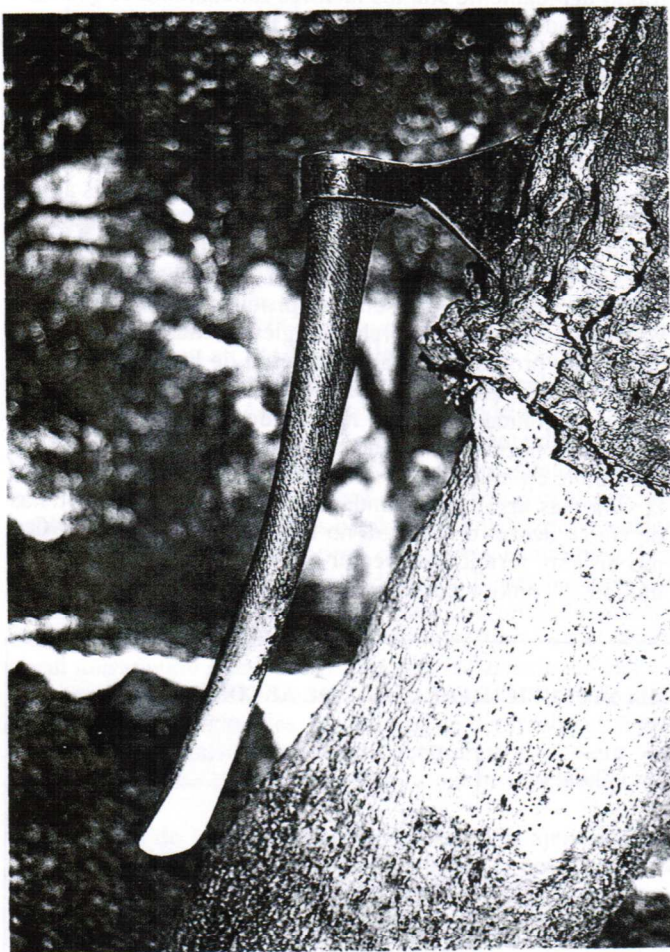
El hacha corchera, una herramienta hoy por hoy insustituible.
